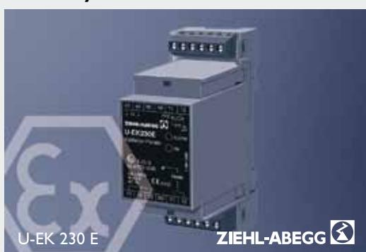
Motorvollschtz durch Temperaturfühler (Kaltleiter) in Verbindung mit dem Auslösegerät U-EK 230 E. Das Auslösegerät trennt den Motorstromkreis über einen separaten Schütz vom Netz, wenn die Nennansprechtemperatur des Temperaturfühlers überschritten wird.
